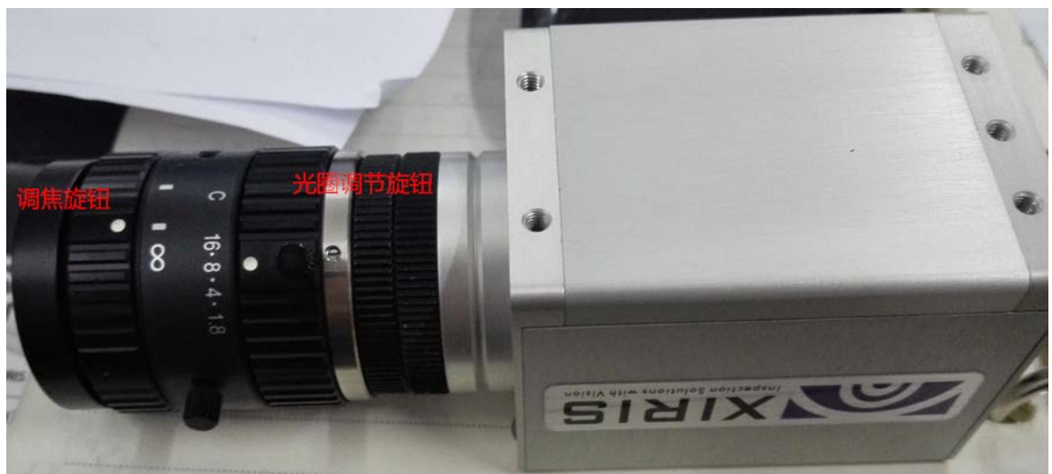
焦距调节旋钮和光圈调节旋钮示意图
